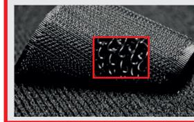
**MF - molded foam:** die gepolsterte hochbelastbare Schale ist ein thermomechanisch unter Hitze und hohem Druck gepresster, geformter Schaumstoff - formstabil, abwaschbar, leicht und robust.
